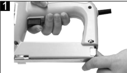
Trekk magasinskyveren bakover og ut av den elektriske stiftmaskinen (fig. 2).
