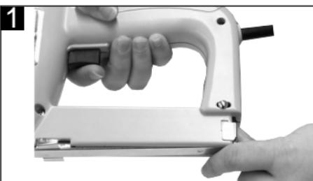
Træk slæn på magasinet bagud ud af hæfte-maskinen (fig. 2).
