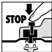
Skiveutskifting skjer enkelt ved å fastlåse spindelen. Spindelfastlåsing trykkes og slipeskiven låses. Flensmutteren åpnes ved hjelp av fronthullnøkkelen. Slipe- eller deleskiven byttes ut, og flensmutteren trekkes til ved hjelp
