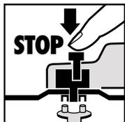
Enkelt skivbyte genom spindelstlåsning. Tryck på spindelstlåsningen så att slipskivan hålls kvar. Öppna flänsmuttern med en stjärnhålnyckel. Byt slip- eller avskiljningsskiva och dra åt flänsmuttern med stjärnhålnyckeln.
