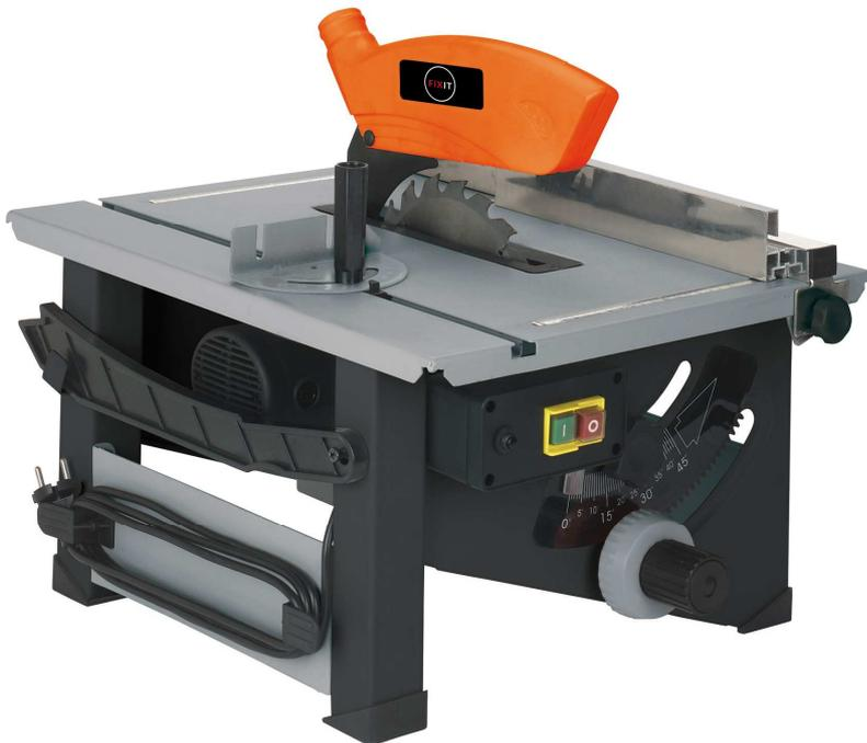
Die Tischkreissäge NTK 900 ist für vielseitige Einsatzmöglichkeiten, für Längs- und Querschnitte bei Massivholz, Spanplatten, Paneelen, furnierte oder beschichtete Möbelplatten und Kunststoffe geeignet. Für Gehrungs- und Schrägschnitte kann die Sägeeinheit um 45° gradgenau geneigt werden. Durch ihre kompakte Bauweise ist die Kreissäge ideal für den mobilen Einsatz. Der Parallelanschlag mit zwei Anschlaghöhen garantiert präzise Schnitte.
