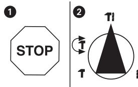
Um eine Beschädigung des Gerätes zu vermeiden, soll die Umschaltung zwischen den einzelnen Funktionen nur im Stillstand erfolgen.
