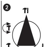
Om een beschadiging van het gereedschap te voorkomen dient de omschakeling tussen de verschillende functies enkel in stilstand te gebeuren.
