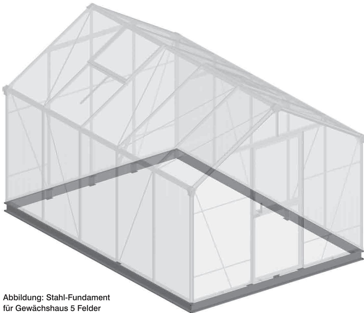
Abbildung: Stahl-Fundament für Gewächshaus 5 Felder
