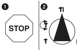
Om een beschadiging van het gereedschap te voorkomen dient de omschakeling tussen de verschillende functies enkel in stilstand te gebeuren.
