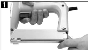
Træk slåen på magasinet bagud af hæftemaskinen (fig. 2).
