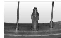
Adaptér pro ventilek umožňuje jednoduché huštění pneumatik jízdních kol.
