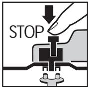
Einfacher Scheibenwechsel durch Spindelretrierung. Spindelretrierung drücken und Schleifscheibe einrasten lassen. Die Flanschnutter mit dem Stirnlochschlüssel öffnen. Schleif- oder Trennscheibe wechseln und Flanschnutter mit dem Stirnlochschlüssel festziehen.
