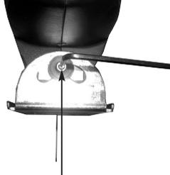
Durch Lösen der Schraube kann der Sägeschuh nach links und rechts oder im Winkel bis 45° verstellt werden.
