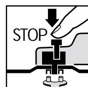
Eenvoudige verwisseling van schijf door spilvergrendeling. De spilvergrendeling indrukken en de slijpschijf vergrendelen. De flensmoer met behulp van de voorgatsleutel open draaien. Verwissel van slijp- of snijschijf en draai dan de flensmoer met de voorgatsleutel weer vast.
