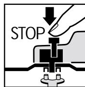
Einfacher Scheibenwechsel durch Spindelarretierung.
