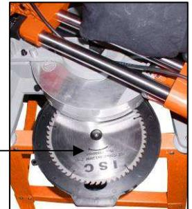
praktische Sägeblattablage auf der Geräterückseite
