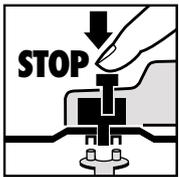
A troca dos rebolos é fácil devido ao bloqueio do fuso. Aperte o bloqueio do fuso e deixe engatar o rebolo.
