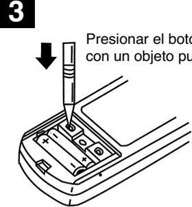
Presionar el botón de ajuste del reloj con un objeto puntiagudo.
