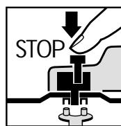
Einfacher Scheibenwechsel durch Spindelarretierung.
