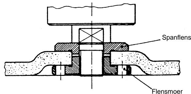
**2 Plaatsing van de flensen bij gebruik van een gebogen snijschijf**
