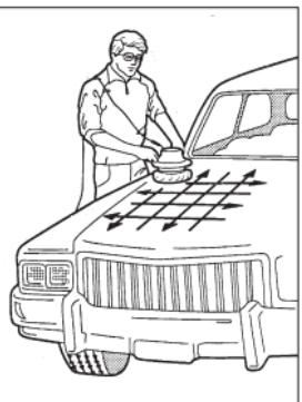
Daarna gaat U over tot het bewerken van de kleinere oppervlakken (b.v. deuren). Laat de netkabel vrij hangen en hou de machine zoals afgebeeld.
