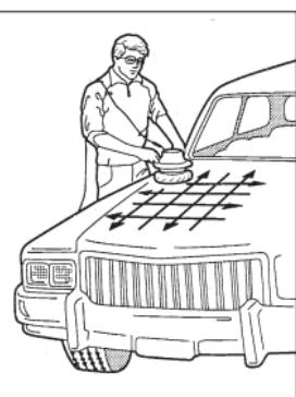
Maintenant, retirez le capot à polir textile et remplacez-le par le capot fin que vous montez sur le disque à polir. Veillez à ce qu'il soit sans impuretés. Polissez la surface dans le même ordre où vous avez appliqué le produit de polissage.
