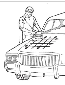
Vaihda nyt kankaisen kiilotushupun tilalle hieno kiilotushuppu ja vedä se kiilotuslautasen päälle. Huolehdi siitä, että kiilotuslautanen on puhdas. Poista kiiloitusainekerros samassa järjestyksessä kuin se on laitettu.
