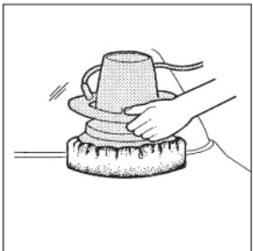
Leg de verlengkabel over Uw schouder en bewerk eerst de effen en grote oppervlakken zoals b.v. motorkap, bagageruimtedeksel en dak. Werk met gelijkmatige bewegingen.
