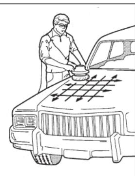
Övergå til behandling av de mindre ytorna (t.ex. dörrarna). Låt sladden hänga fritt och håll maskinen som på bilden.
