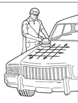
Tauschen Sie nun die Textil-Polierhaube gegen die feine Polierhaube aus, und ziehen Sie sie über den Polierteller. Achten Sie darauf daß dieser frei von Verunreinigungen ist. Entfernen Sie die Polierschicht in gleicher Reihenfolge, wie Sie das Poliermittel aufgetragen haben. **Achtung! Üben Sie keinen Druck auf die Poliermaschine aus!**
