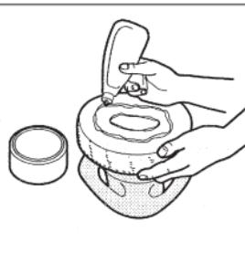
Depois passe a lustrar as superfícies menores (p.ex. as portas). Deixe o cabo de extensão suspenso livremente e segure a máquina conforme a ilustração.
