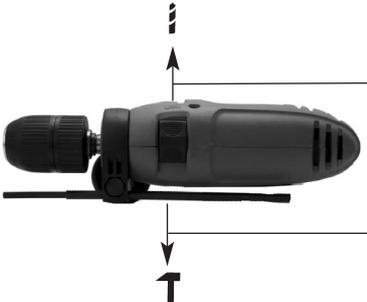
Schiebeschalter in Stellung Bohren. **Nur im Stillstand umschalten!**
