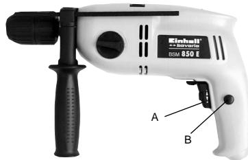
**Størmafbryder:****Start:** Tryk på afbryderen A.**Kontinuerlig drift:** Sikr afbryderen A med låsknappen B**Stop:** Tryk kort på afbryderen A.
