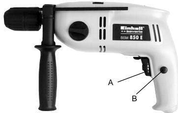
**Pois-/pääällekytkin****Kytken tähän päälelle:** Paina kytkintä A.**Kestokäyttö:** Varmista kytkintä A lukitsimella B.**Kytken tähän pois päältä:** Paina nopeasti kytkintä A.
