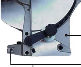
Bohrungslöcher zum Befestigen der Grundplatte
