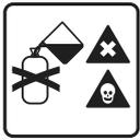
**Keine giftigen Sprühmittel in den Druckbehälter füllen und versprühen!**
