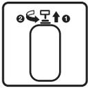
**Pumpenhebel herausziehen auf Anschlag und nach links herausdrehen.**
