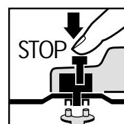
Eenvoudige verwisseling van schijf door spilverbredeling. De spilverbredeling indrukken en de slijpschijf vergrendelen. De flensmoer met behulp van de voorgatsleutel open draaien. Verwissel van slijp- of snijschijf en draai dan de flensmoer met de voorgatsleutel weer vast.
