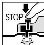
Einfacher Scheibenwechsel durch Spindelarretierung.
