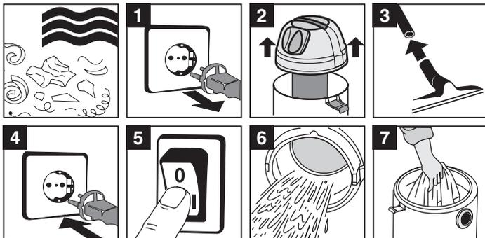
Ⓓ Zum Naßsaugen ziehen Sie den beiliegenden Schaumstofffilter über den Filterkorb (Bild 2) Der bei der Lieferung enthaltene Schmutzfangsack, die Papierfiltertüten und der Faltenfilter sind nicht für das Naßsaugen geeignet!
