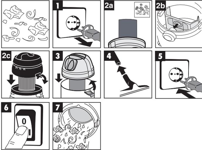
Ⓢ Zum Trockensaugen befestigen Sie die Papierfiltertüte (Bild 2a) auf dem Filterkorb und sichern diese mit dem Gummiring. Die Papierfiltertüte ist nur für das Trockensaugen geeignet!
