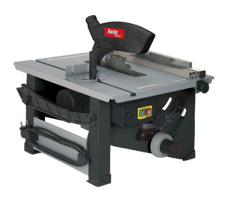
Die Tischkreissäge PB-TK 900 ist für vielseitige Einsatzmöglichkeiten, für Längs- und Querschnitte bei Massivholz, Spanplatten, Paneelen, furnierte oder beschichtete Möbelplatten und Kunststoffe geeignet. Für Gehrungs- und Schrägschnitte kann die Sägeeinheit um 45° gradgenau geneigt werden. Durch ihre kompakte Bauweise ist die Kreissäge ideal für den mobilen Einsatz.
