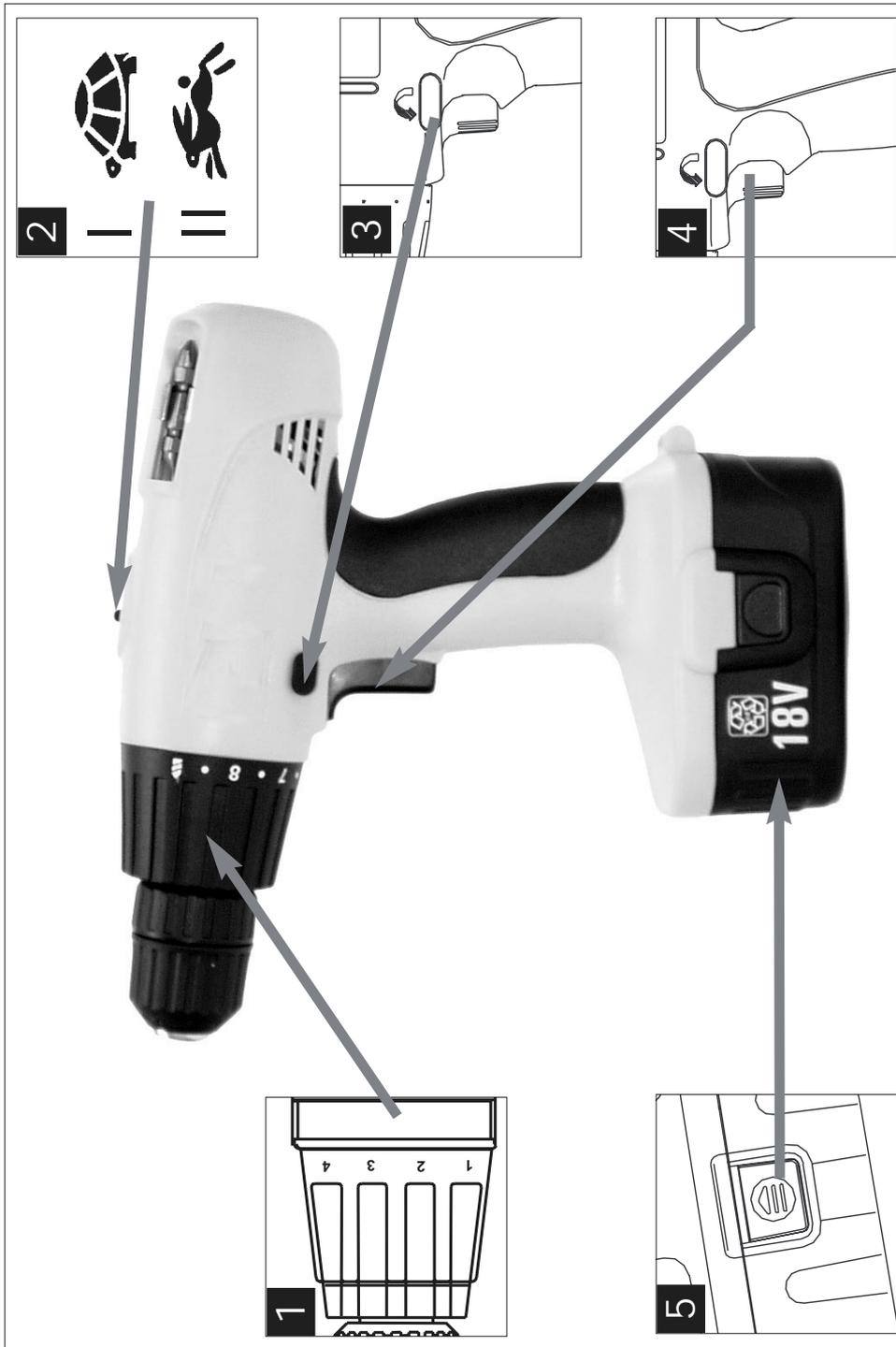
**D****Geräteabbildung:****Bild 1: Drehmomenteinstellung****Bild 2: Umschaltung 1. Gang / 2. Gang****Bild 3: Umschaltung Links-Rechtslauf****Bild 4: Ein-/Ausschalter****Bild 5: Wechselakku, zur Entnahme des Akku-Packs beide Rasttasten drücken****Wichtige Hinweise:**
