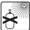
Ne pas exposer les réservoirs sous pression à l'ensoleillement sur une longue durée !
