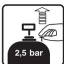
**Prima di ogni operazione di pulizia e manutenzione eliminate la pressione dal serbatoio! Tirate la valvola di sovrappressione verso l'alto e scaricate la pressione!**
