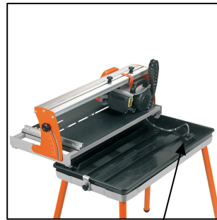
Wasserauffangwanne mit integrierter Pumpe zur Kühlwasserförderung
