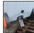
Integrierter Wasserablass an der Geräterückseite
