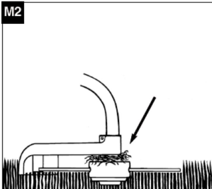
**Vorsicht:** Entfernen Sie regelmäßig alle Rasen- und Unkrautreste um ein Überhitzen des Schaftrohrs zu vermeiden. Rasen-/ Gras-/ Unkrautreste fangen sich unterhalb des Schutzschields (Abb. M2), dies verhindert eine ausreichende Kühlung des Schaftrohrs. Entfernen Sie die Reste vorsichtig mit einem Schraubenzieher oder dergleichen.
