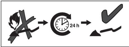
Per la pulizia della stufa e dei focolari, aspettate minimo 24 ore, in modo che questi si siano raffreddati e che il fuoco si sia sicuramente spento. Soltanto per ceneri fredde, si vedano le istruzioni per l’uso!
