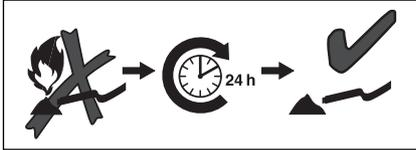
Vänta i minst ett dygn innan du suger rent eldstäder eller öppna spisar. Detta krävs för att garantera att elden har slocknat och askan svalnat till en säker temperatur. Endast för kall aska, se bruksanvisningen!
