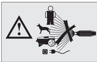
**Warnung!** Hochdruckstrahlen können bei unsachgemäßen Gebrauch gefährlich sein. Der Strahl darf nicht auf Personen, Tiere, aktive elektrische Ausrüstung oder auf das Gerät selbst gerichtet werden.
