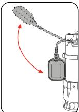
WARNING! MAKE SUR THAT THE FLOAT SWITCH DOES NOT TOUCH THE BOTTOM BEFORE SWITCHING OFF TO AVOID THE RISK OF RUNNING DRY.
