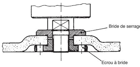
2 Disposition des brides en cas d'utilisation d'une meule tronçonneuse contre-coudeé
