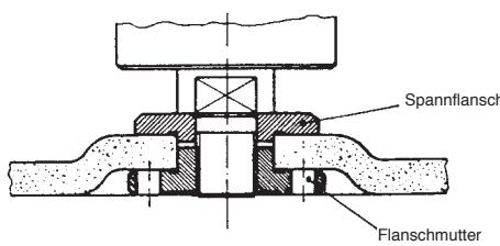
**2 Anordnung der Flansche bei Verwendung einer gekröpften Trennscheibe**
