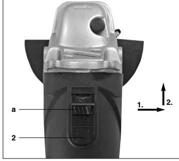
⊕ Der Winkelschleifer ist mit einem Sicherheitsschalter zur Unfallverhütung ausgestattet. Zum Einschalten den Schieber (a) nach rechts schieben und gleichzeitig den Ein-/Ausschalter (2) nach vorn schieben und niederdrücken. Zum Ausschalten des Winkelschleifers die Taste (2) hinten niederdrücken. Die Taste (2) springt in die Ausgangsstellung zurück.
